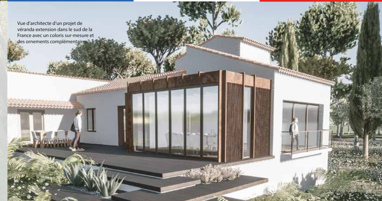
Exemple de réalisation où la couverture dépasse la structure périphérique de la véranda.
